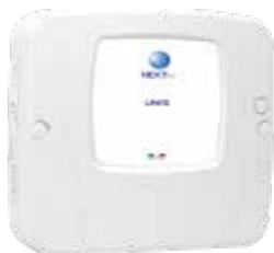
LINK5 Sistema di sicurezza dotato di: 4 ingressi filari, 7 ingressi tecnici di supervisione, 3 uscite di segnalazione. L'inserimento del modulo radio opzionale rende disponibili 32 ingressi radio. 1 Bus seriale per il collegamento dei periferici del Sistema.
